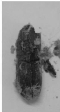
Рисунок 1. Образец необработанной древесины после огневой обработки
