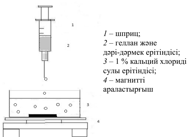
2-сурет. Туберкулезге қарсы препараттар енгізілген геллан капсулаларын алу схемасы
